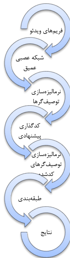
(شکل-۱): سیستم تشخیص وقایع بصری: فریم‌های ویدئو با CNN پردازش شده و سپس، نرمالیزه و کدگذاری می‌شوند.
