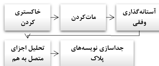
(شکل-۱۳): روش پیشنهادی در بخش جداسازی نویسه‌های پلاک (Figure-13): Overview of the proposed character segmentation
