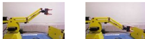
الف) وضعیت ربات با تنظیم عدد ۱ در محدوده کاری مفصل آرنج ب) وضعیت ربات با تنظیم عدد ۱۲۷ در محدوده کاری مفصل آرنج
