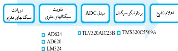
(شکل-۹): دیاگرام بلوکی اجزای سخت‌افزاری سیستم سخت
