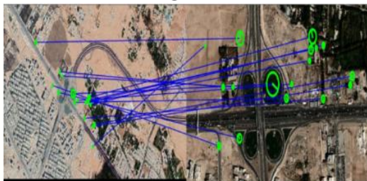
(شکل-۲۰): نتایج حاصل از اعمال روش پیشنهادی و روش LightGlue به تصاویر سنجش از دور دارای چرخش و تفاوت مقیاس شدید
