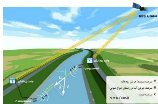
(شکل 1- الگوی مفهومی سامانه تیکه‌نگاری صوتی [7]) (figure-1) Conceptual Pattern of Fluvial Acoustic Tomography System [7]
