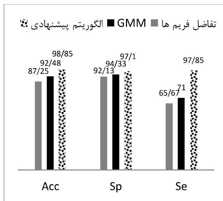
(شکل-۵): درصد تشخیص سه الگوریتم تفرق قاب‌ها، GMM و Vibe بهبود یافته در تشخیص سقوط افراد.
