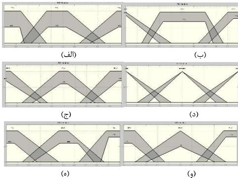
(شکل-۴): توابع عضویت به دست آمده برای شش متغیر (الف) نسبت اندازه تصویر، (ب) بردار حرکت، (ج) مرکز ثقل، (د) حافظه حرکت، (ه) زاویه بین قطر بزرگ بیضی محاط و محور افقی، (و) نسبت قطر بزرگ به قطر کوچک بیضی محاط.
