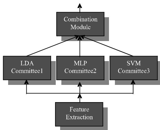
شکل ۶: ساختار ماشین همیار به کار رفته [۳۱].
