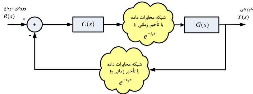
(شکل-۲): ساختار کلی سامانه کنترل از طریق شبکه با در نظر گرفتن چالش تأخیر تصادفی شبکه.
