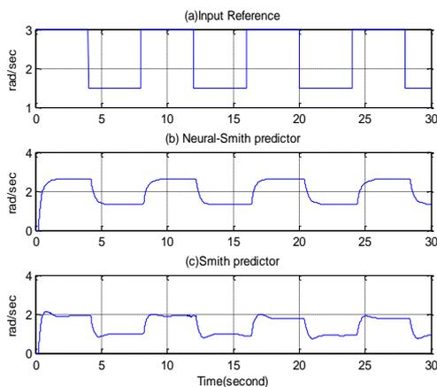
(شکل-۱۳): نتیجه شبیه‌سازی سامانه کنترل از طریق شبکه به‌ازای تأخیر ۹۰۰-۱۱۰۰ میلی‌ثانیه و  $\alpha=0.5$ : الف) سیگنال مرجع؛ ب) سیگنال خروجی دستگاه به‌ازای استفاده از کنترل‌گر عصبی-اسمیت پیش‌بین؛ ج) سیگنال خروجی دستگاه به‌ازای استفاده از کنترل‌گر اسمیت پیش‌بین ساده.
