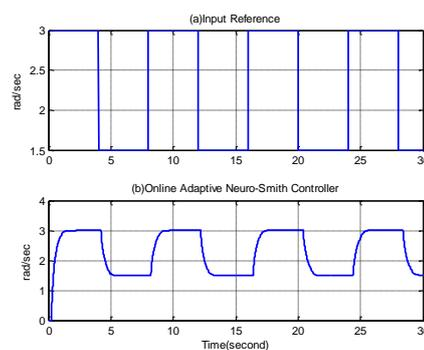
(شکل-۹): نتیجه شبیه‌سازی سامانه کنترل از طریق شبکه با استفاده از کنترل‌گر عصبی‌اسمیت پیش‌بین به‌ازای تأخیر  $400-600$  میلی‌ثانیه و  $\alpha=0$  (الف) سیگنال مرجع. ب) سیگنال خروجی دستگاه به‌ازای استفاده از کنترل‌گر عصبی‌اسمیت پیش‌بین.
