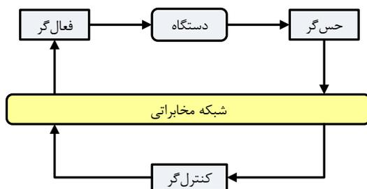
(شکل 1-): ساختار کلی سامانه کنترل از طریق شبکه.
