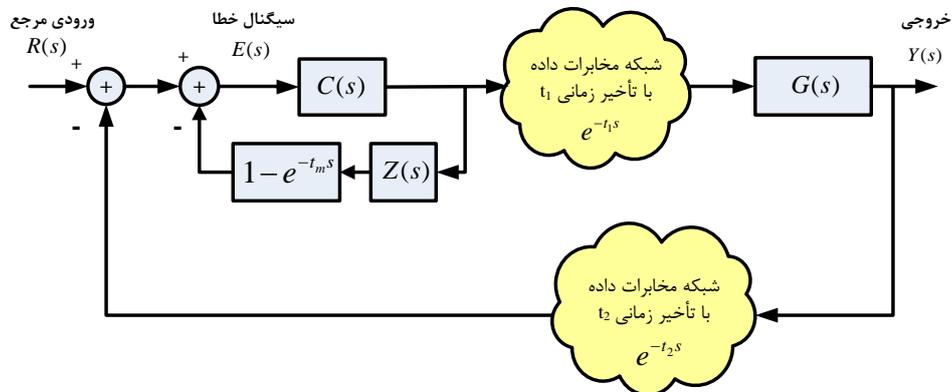
(شکل-۳): ساختار سامانه کنترل از طریق شبکه با در نظر گرفتن کنترل گر اسمیت پیش‌بین.
