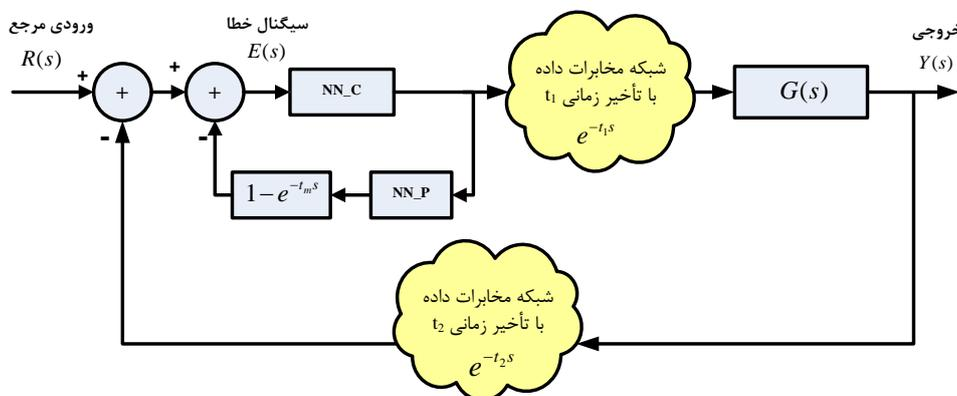
(شکل-۴): ساختار پیشنهادی سامانه کنترل از طریق شبکه با استفاده از کنترل گر عصبی- اسمیت پیش‌بین
