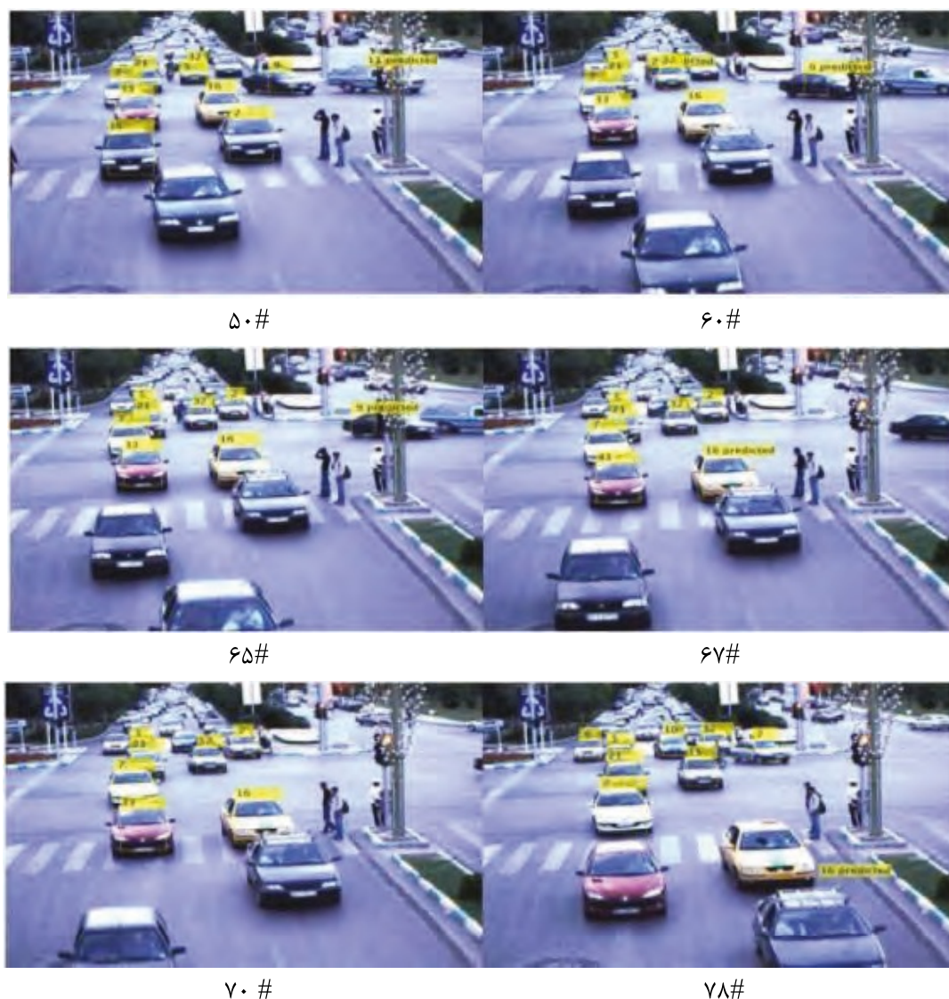
(شکل - ۱۴): نتایج استفاده از الگوریتم پیشنهادی در قاب‌های مربوط به ساعت ۹ صبح
