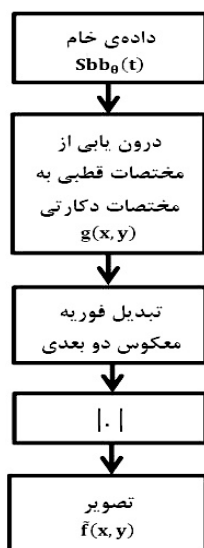
(شکل-۶): روندنمای الگوریتم تشکیل تصویر PFA در حالت
