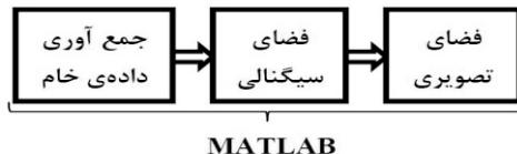
(شکل-۹): ساختار استفاده شده در کارهای قبلی برای پیاده‌سازی نرم‌افزاری مدل عملکرد SAR در بخش تشکیل تصویر
