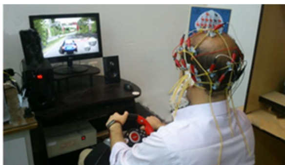
(شکل-۳): یکی از داوطلبان در حین انجام آزمایش رانندگی (Figure-3): A volunteer testing the driving simulator
