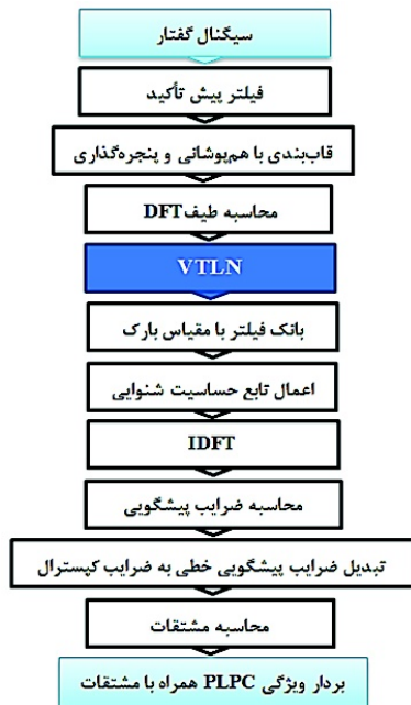
(شکل-۱): به‌کارگیری روش VTLN در روش استخراج ویژگی PLPC
