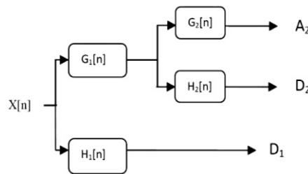
شکل-۲): روش بانک فیلتر در تجزیه سیگنال [n] به زیر باندهایش (Figure -2): Sub-band decomposition of DWT implementation
