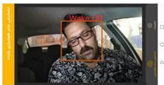
(شکل -۱۴): حالتی که چهره شناسایی شده، اما چشم‌های باز در ناحیه چهره تشخیص داده نشده‌اند. (Figure-14): A state where the face is detected, but the open eyes are not detected in the face area
