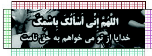
شکل (۱۴) - کادر احاطه‌کننده یک بلوک متن، همراه با بلوک نواحی همسایگی بالا، پایین، چپ و راست.
