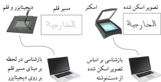
(شکل-۱): بازشناسی دست‌نوشته به دو صورت برخط و برون خط (Figure-1): Offline and online handwritten recognition
