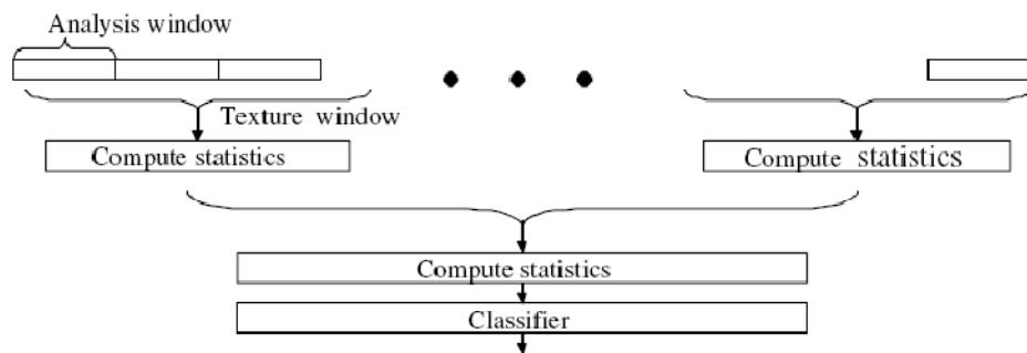
شکل ۱: شناسایی سبک موسیقی با تجمعی بردارهای ویژگی کوتاه‌مدت و میان‌مدت<sup>۱</sup>
