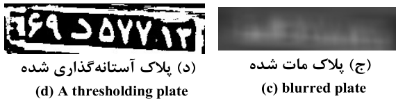
(شکل-۱۴): روش پیشنهادی برای یافتن پلاک باینری (Figure-14): The proposed method for finding binary plates
