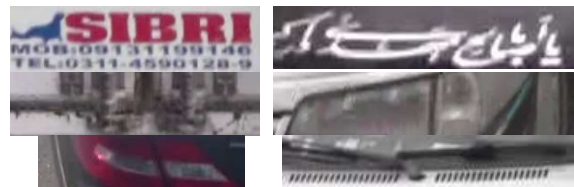
(شکل-۱۲): مثال‌هایی از نواحی غیر پلاک استخراج‌شده (Figure-12): Examples of non-plate areas
