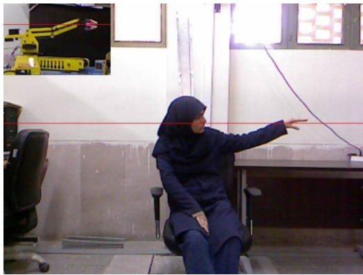
(شکل-۲۰): برآورد حالت‌های پویای دست مربوط به باز و بسته شدن انگشتان
