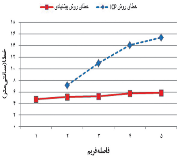
(شکل-۳۳): مقایسه خطای مدل روش پیشنهادی با الگوریتم ICP برای ۶۱ فریم با فاصله‌های مختلف در صحنه سوم
