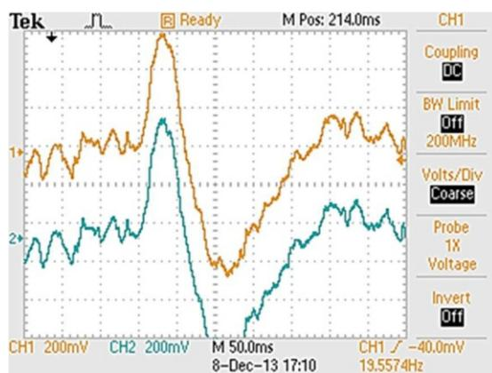
(شکل-۱۱): نمونه ای از سیگنال های دریافتی و پیش تقویت شده حاصل از برد شکل (۱۰) در حین پلکزدن. این سیگنال ها مربوط به دو کانال سیگنال O1 و O2 هستند.
