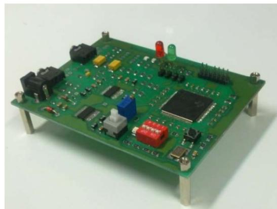
(شکل-۱۲): برد سخت‌افزاری ساخته شده جهت پردازش نهایی سیگنال‌های مغزی (Figure-12): Our DSP processing board
