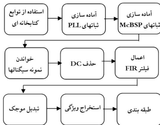
(شکل-۱۳): نمودار جعبه‌ای الگوریتم نرم‌افزاری پیاده‌شده روی برد ساخته شده جهت پردازش سیگنال (Figure-13): Block diagram of implemented software on the DSP board
