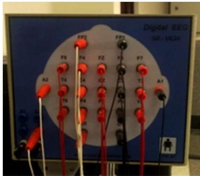
(شکل-۱): صفحه الکتروودها متعلق به سیستم ۲۴ کاناله ثبت سیگنال‌های مغزی مورد استفاده جهت تهیه پایگاه داده
