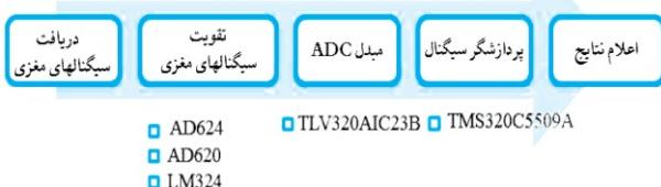
(شکل-۹): دیاگرام بلوکی اجزای سختافزاری سیستم سخت افزاری طراحی شده
