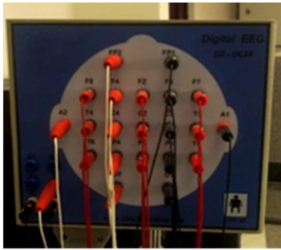
(شکل-۱): صفحه الکترودها متعلق به سیستم ۲۴ کاناله ثبت سیگنال‌های مغزی مورد استفاده جهت تهیه پایگاه داده (Figure-1): The Electrode Panel in the 24-channel EEG signal acquisition system used for database generation
