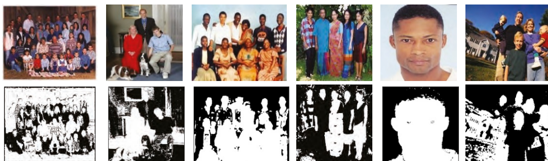
(شکل - ۸) - نتیجه اعمال تنه‌های ماسک پیشنهادی در رابطه (۸) بر روی برخی تصاویر مجموعه داده Pratheepan [11] (Figure-8): Results of the proposed mask from Eq. (8) on some images from Pratheepan dataset [11]
