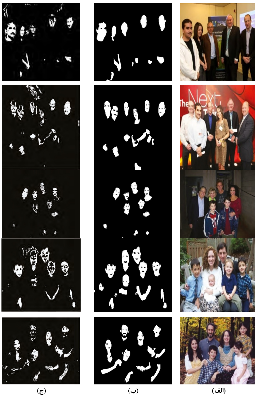
(شکل - ۱۳) - الف: تصویر اصلی، ب: ground truth، ج: نتیجه حاصل از روش پیشنهادی در این مقاله (Figure-13): From right column to left column: Original Images, Ground truth, Results of the method proposed in this work, respectively.
