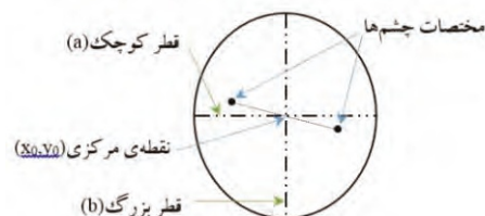
(شکل - ۲): مدل ماسک بیضوی بنا شده روی مختصات چشم‌ها (Figure-2): Elliptic mask model based on eyes points
