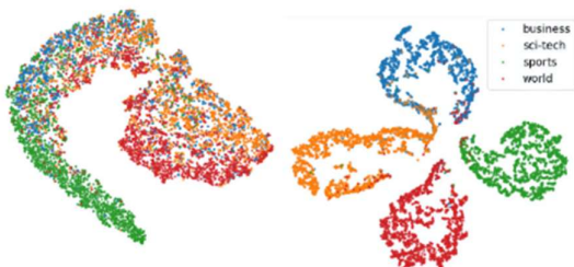
(شکل-۱۲): مصورسازی متون مجموعه داده‌ای شامل اخبار بر مبنای لایه تعبیه هر متن در فضای دو بعدی. از چپ به راست: بردارهای تعبیه در ابتدای آموزش مدل، بردارهای تعبیه در پایان آموزش مدل
