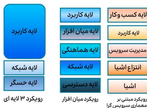
(شکل-۲): سه معماری مطرح در اینترنت اشیا [۱۶] (Figure-2): three proposed architectures in the Internet of Things [16]
