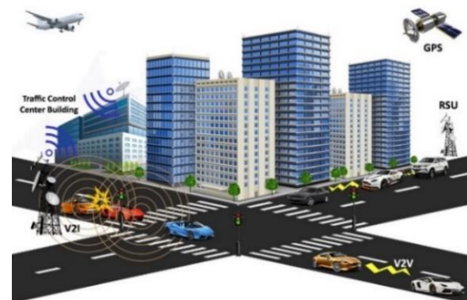
(شکل ۱-): ساختار کلی شبکه‌های موردی بین‌خودرویی [6] (Figure-1): Structure of vehicular ad hoc networks
