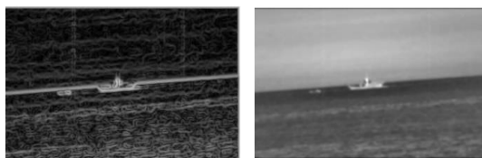
(شکل-۳): اعمال عملیات پیش پردازش. الف: تصویر اصلی. ب: اعمال فیلتر میانه. ج: اعمال روش تعدیل هیستوگرام. د: اعمال فیلتر گوسی. ه: گرادیان تصویر هموار شده در دو جهت افقی و عمودی
