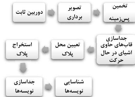
(شکل-۱): ساختار کلی سامانه خودکار آشکارسازی و شناسایی پلاک خودرو (Figure-1): Structure of ANPR system
