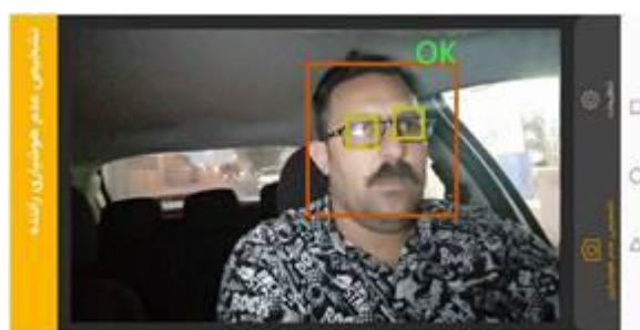
(شکل-۱۲): حالتی که چهره و دو چشم تشخیص داده شده‌اند. (Figure-12): The state where the face and two eyes are detected.
