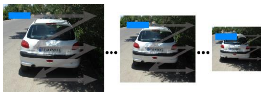
(شکل-۲): تشخیص اشیا به صورت چندمقیاسی. مستطیل آبی‌رنگ پنجره جستجو را نشان می‌دهد. (Figure-2): Multi-scale object detection. Search windows is shown by blue rectangle.
